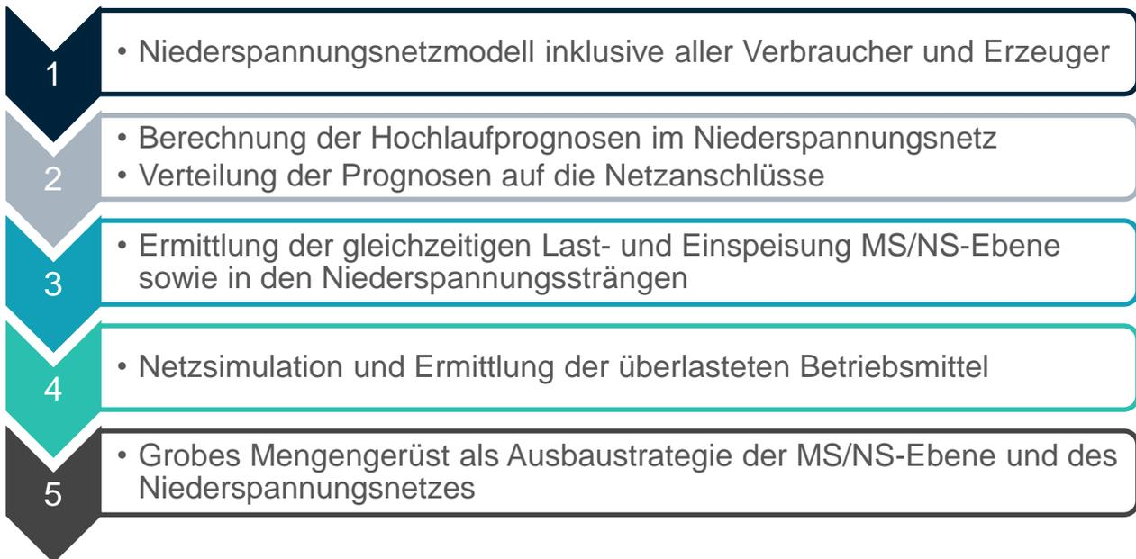
Für die Ermittlung des Netzausbaubedarfs in der Niederspannung und Umspannung MS/NS wird der digitale Zwilling der FairNetz als Netzmodell zugrunde gelegt. Im Anschluss werden je Teilnetzgebiet und Betrachtungsjahr die Hochlaufzahlen, wie in den Kapiteln 2.2, 2.3 und 2.4 abgebildet, auf die bestehenden Netzanschlüsse gleichmäßig verteilt. Im Anschluss wird je eine Berechnung des Lastfalles und des Einspeisefalles umgesetzt.
